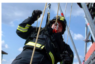
Die Leine ist im Gurt des Gerätes eingelassen.
